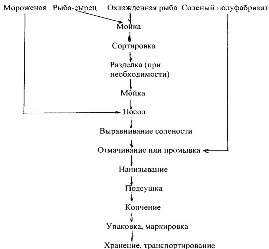
Рис. 1 Технологическая схема обработки рыбного сырья
